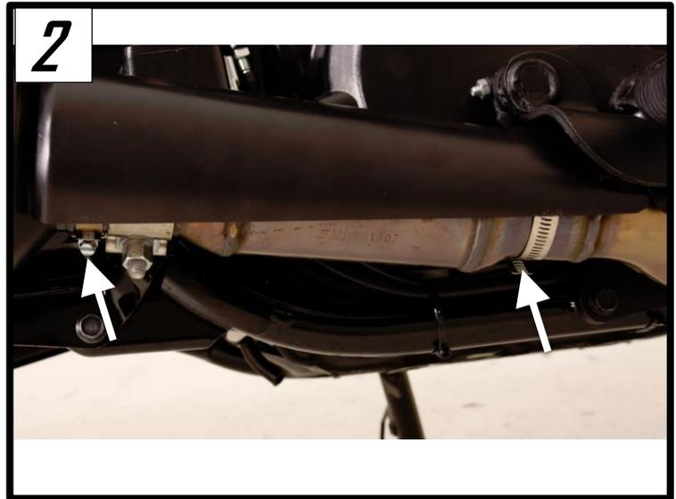
Demontieren Sie die Muttern des Serienhalters. (Abb.3), lösen Sie anschließend die Schelle und demontieren Sie den Schalldämpfer (Abb.4)
